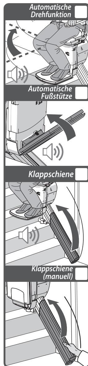
Die nebenstehende Illustration zeigt die Elemente, mit denen Sie den SMART Sitz lift bedienen. Um den Sitzkomfort und die Bedienungsfreundlichkeit zu erhöhen, können Sie den SMART Sitz um folgende Optionen erweitern: automatischer Drehsitz, automatische Fußstütze und der Klappschiene.
